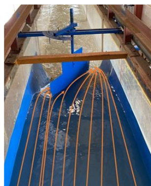
شکل ۵ نحوه تقسیم جریان بین طرفین دریچه‌وار
