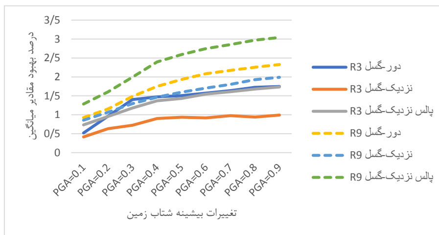
شکل ۱۲ ارزیابی اثر کنترل فازای در مقایسه با کنترل بهینه خطی بر بیشینه و جذر مجموع مربعات شتاب تحت تأثیر انواع زلزله در پرپود 1/3 ثانیه
