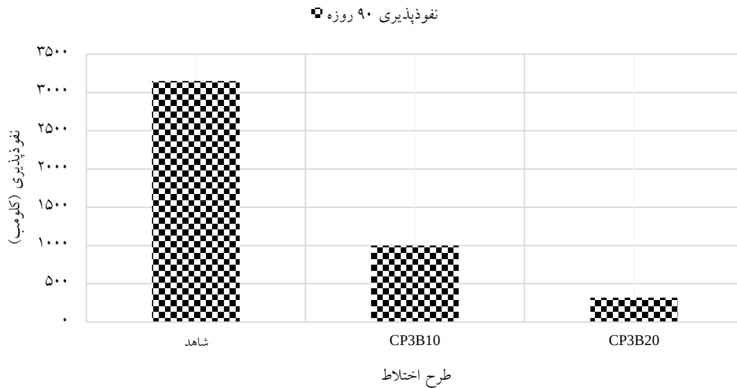
شکل ۱۹ تغییرات نفوذپذیری ۹۰ روزه نمونه‌های بتن سبز حاوی خاکستر باگاس و مقدار ثابت ۳ درصد الیاف پلی‌پروپیلن
