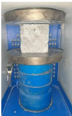
شکل ۶ آزمایش مقاومت فشاری نمونه‌های بتن سبز حاوی الیاف پلی -
