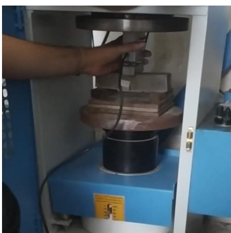
شکل ۵ لحظه شکست نمونه
