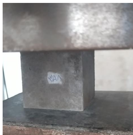
شکل ۲ نحوه قرار گیری نمونه
