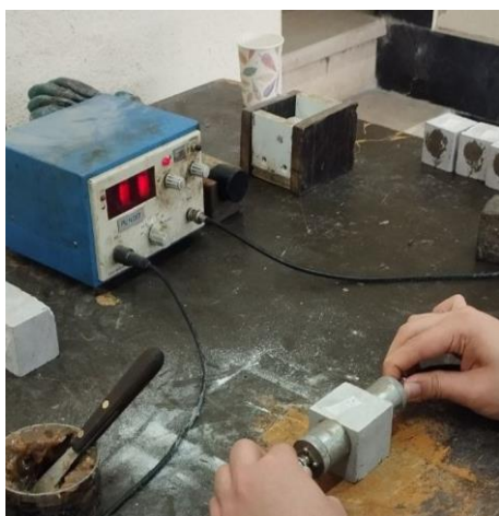
شکل ۸ انجام آزمایش التراسونیک
