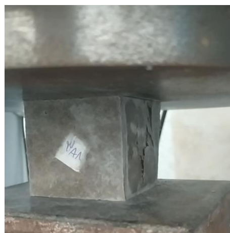
شکل ۳ لحظه شکست نمونه
