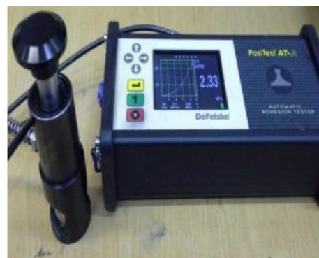
شکل ۲ قرارگیری نمونه ها در آزمایش PULL OFF
