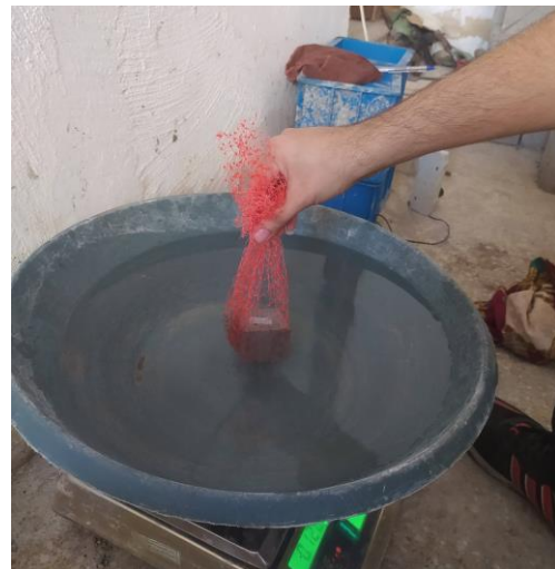
شکل ۱۴ وزن کردن نمونه
