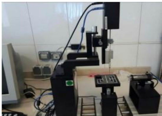
شکل ۳ دستگاه اندازه گیری زاویه تماس
