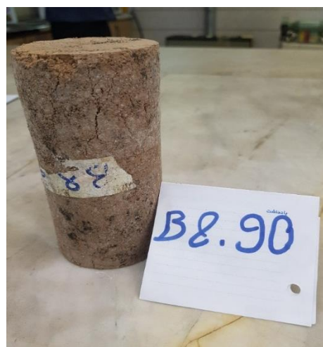
شکل ۱۴ نمونه تثبیت شده به روش زیستی با غلظت ۸ گرم بر لیتر محلول بتاگلوکان
