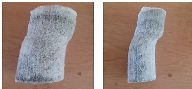
شکل ۱۲ نمونه تغییر شکل یافته ستون سنگی مسلح
