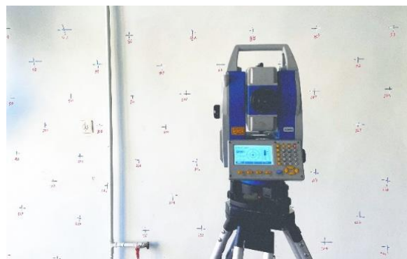
شکل ۳ قرائت نقاط کنترل به‌صورت محلی
