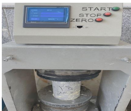
شکل ۷ آزمون مقاومت فشاری نمونه‌ها توسط جک
