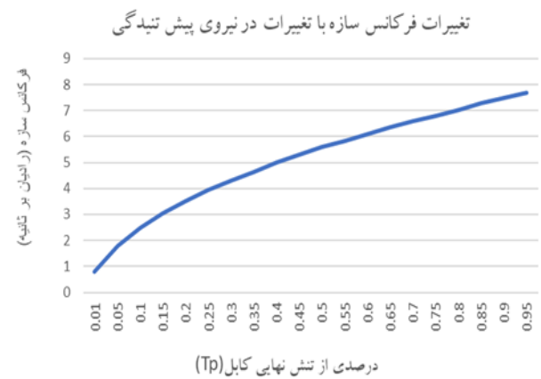
شکل ۱۳ تغییرات فرکانس طبیعی سیستم بر حسب تغییرات مقادیر نیروی پیش تنیدگی کابل به صورت درصدی از تنش نهایی کابل
