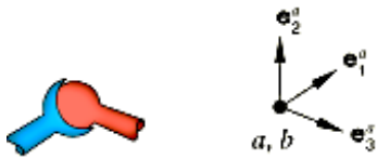
شکل ۸ اتصال دهنده مفصلی در نرم افزار آباکوس
