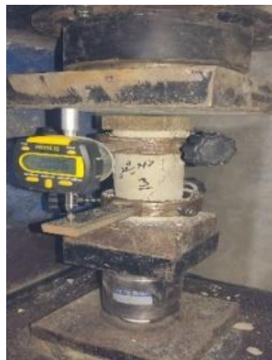
شکل ۷ نمونه استوانه‌ای تحت آزمایش مدول الاستیسیته
