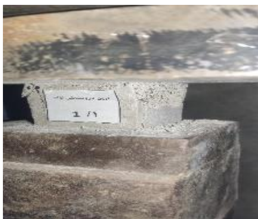
شکل ۳ مقاومت فشاری نمونه ملات ژئوپلیمر ساخته شده از کائولن و سرباره
