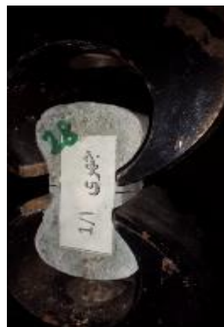
شکل ۴ شکست نمونه بریکت در آزمایش کشش مستقیم
