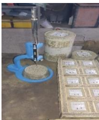
شکل ۶ گیرش نمونه آزمایشی تحت آزمایش ویکات
