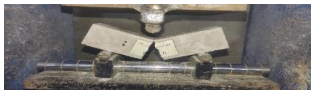
شکل ۴ مقاومت خمشی سه نقطه‌ای نمونه ملات ژئوپلیمر ساخته شده از کائولن و سرباره
