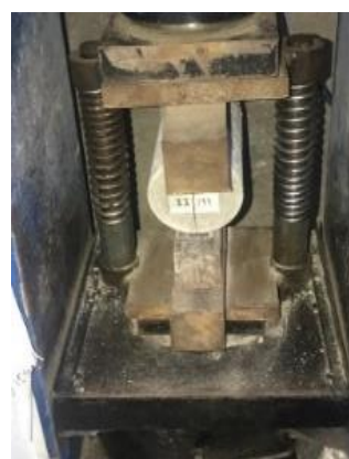
شکل ۵ نمونه استوانه‌ای تحت آزمایش کشش برزیلی
