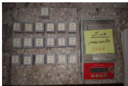
شکل ۵ توزین نمونه‌ها در آزمایش جذب آب
