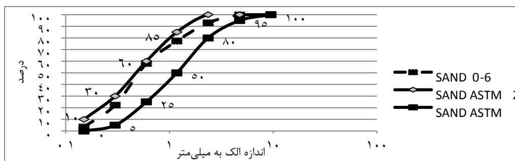
شکل ۱ منحنی دانه بندی ماسه مصرفی بر اساس ASTM C۳۳ [21]
