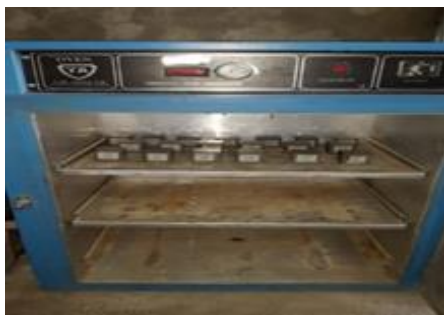
شکل ۶ قرارگیری نمونه‌ها در اون برای آزمایش جذب آب
