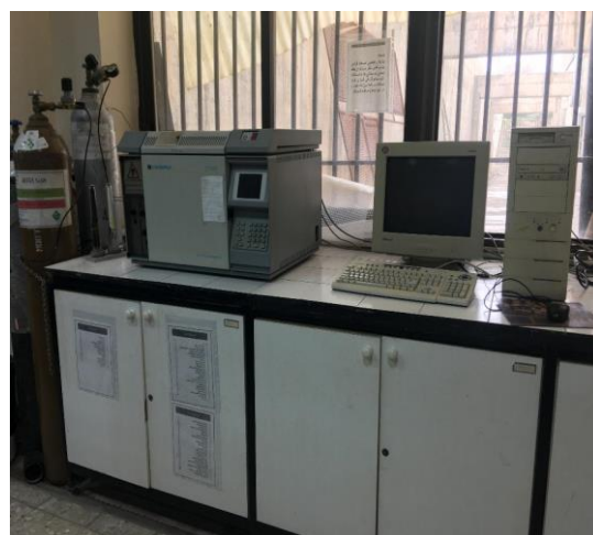
شکل ۲ دستگاه کروماتوگرافی گازی مورد استفاده در پژوهش
