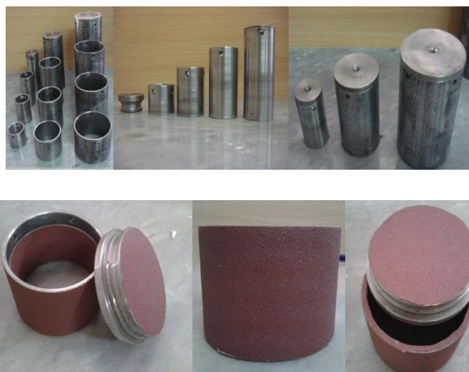
شکل ۵ تصاویر مدل‌های پی لبه‌دار با ابعاد و زبری مختلف
