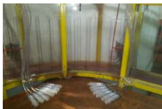
شکل (۶): بستر متحرک در کف فلوم رسوباتی (جنس پلی استایلن) و طرز قرار گرفتن سیفون‌ها
