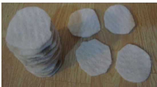
شکل ۱۵ ورقه‌های افقی ژئوتکستایل مورد استفاده در تسلیح ستون سنگی
