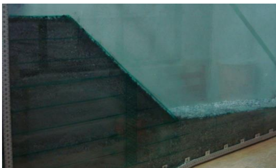
شکل ۱۱ مدل شیب مسلح با ستون سنگی معمولی
