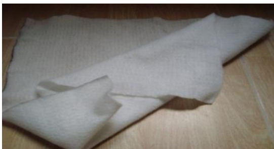
شکل ۵ لایه ژئوتکستایل استفاده شده در آزمایشگاه
