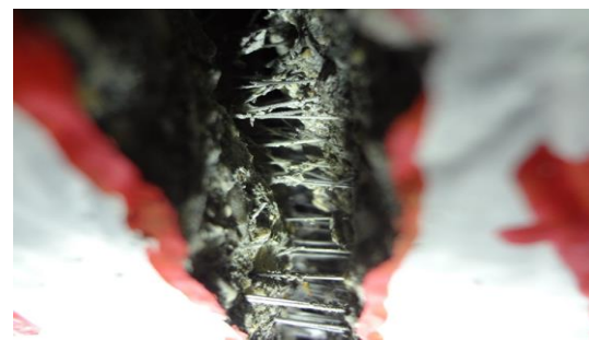
شکل ۹ پل زدن الیاف در تیر RHN0.5
