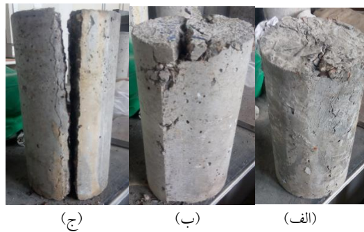
شکل ۲۳ گسیختگی کششی نمونه‌های استوانه‌ای تحت کشش غیرمستقیم
