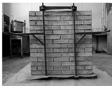
شکل ۵ سیستم حمل دیوار
