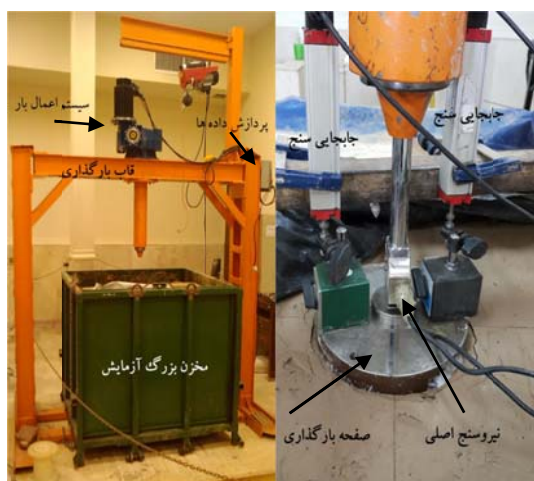
شکل ۲ مخزن و دستگاه بارگذاری و ثبت بار
