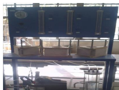
شکل ۶ دستگاه تست نفوذناپذیری آب طبق استاندارد EN 12390-8
