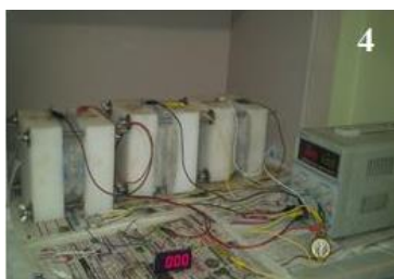
شکل ۴ مراحل انجام آزمایش نفوذ تسریع‌یافته یون کلرید: (۱) برش نمونه استوانه‌ای به ارتفاع ۵ سانتی‌متر، (۲) عایق کردن نمونه با رزین، (۳) قرارگیری نمونه‌ها در محفظه خلا، (۴) ثبت بار الکتریکی عبوری از نمونه توسط دستگاه عبور جریان
