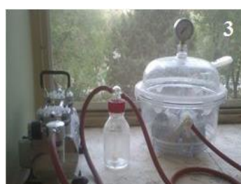
شکل ۴ مراحل انجام آزمایش نفوذ تسریع‌یافته یون کلرید: (۱) برش نمونه استوانه‌ای به ارتفاع ۵ سانتی‌متر، (۲) عایق کردن نمونه با رزین، (۳) قرارگیری نمونه‌ها در محفظه خلا، (۴) ثبت بار الکتریکی عبوری از نمونه توسط دستگاه عبور جریان
