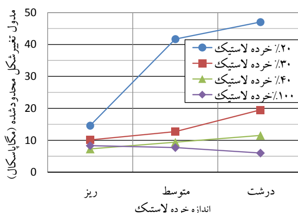
شکل ۱۶ تغییرات مدول تغییر شکل محدود شده با اندازه خرده لاستیک
