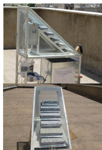
شکل ۱ طرح شماتیک فتورآکتور خورشیدی مورد استفاده: A: پلکان بتنی، B: مخزن تغذیه، C: پمپ، D: شیر نمونه‌گیری، E: حمام ترموستاتیک، F: لوله رابط، G: سرریز، H: هواده، I: صفحات شیشه‌ای ۳ میلی‌متر
