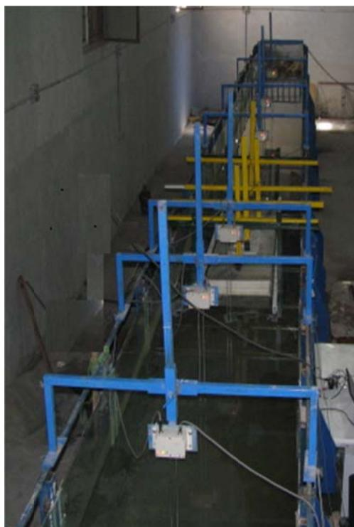
شکل (۶) نمایی از فلوم آزمایشگاه هیدرولیک دانشگاه تحصیلات تکمیلی صنعتی و فناوری پیشرفتۀ کرمان با طول  $۱۶$  متر، عرض و ارتفاع یک متر
