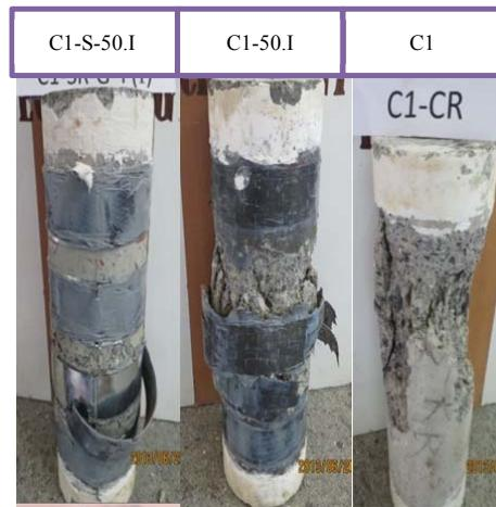
شکل ۵ نحوه زوال و شکست نمونه‌ها، (الف) نمونه شاهد (ب) نمونه بدون لایه میانی (ج) نمونه با لایه میانی
