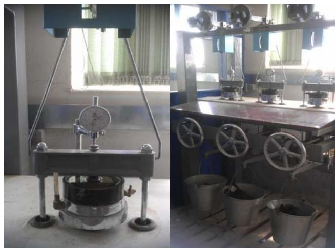
شکل ۴ دستگاه آزمایش تحکیم یکبعدی
