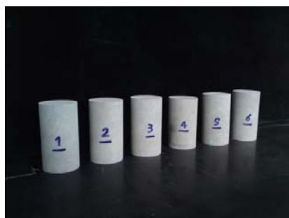
شکل ۴ نمونه‌های ماسه‌سنگ پس از مغزه‌گیری و برش
