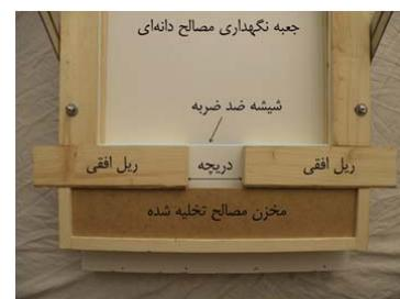
شکل ۲ نمای رو به رو از دستگاه توسعه یافته دریچه
