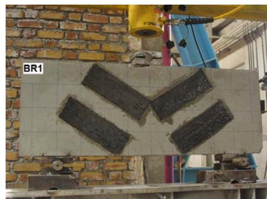
شکل ۳ آرایش CFRP در تیر BR1
