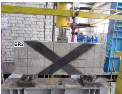
شکل ۴ آرایش CFRP در تیر BR2
