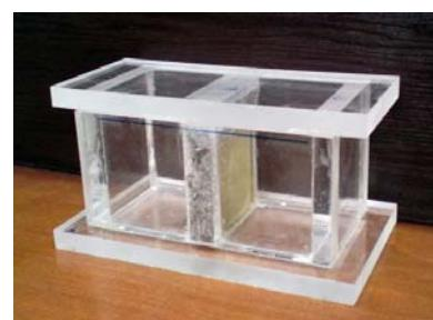
شکل ۲ شکل شماتیک مدل آزمایشگاهی برای سنگ مارن
