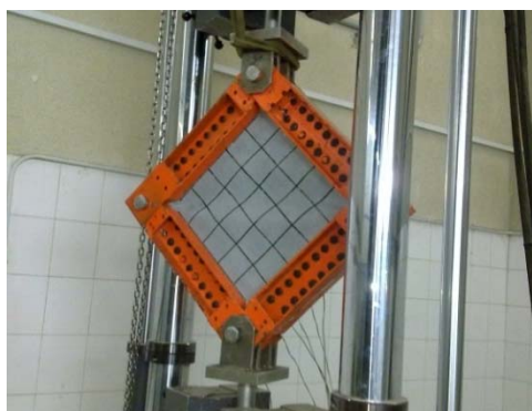
شکل ۱۴ عدم مشاهده‌ی پدیده‌ی لایه‌شدن و پارگی در لایه‌ی پلیمری نمونه‌ی CSPSP4 (وضعیت نمونه در تغییر مکان نسبی ۲٪)
