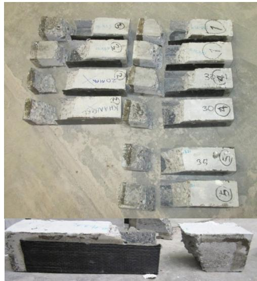
شکل ۱۴ شکست تیرهای تقویت شده با CFRP
