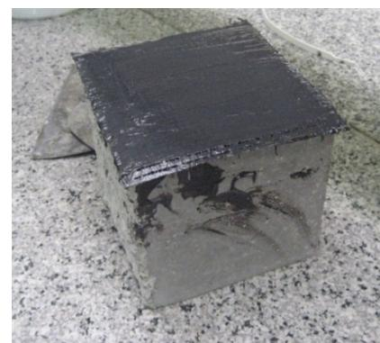
شکل ۱ قرار دادن صفحه‌ی الیاف کربنی روی چسب‌های اعمال شده
