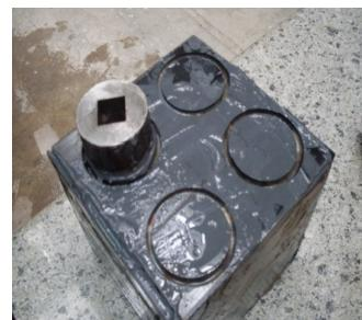
شکل ۶ چسباندن استوانه‌ی فولادی به سطح CFRP
