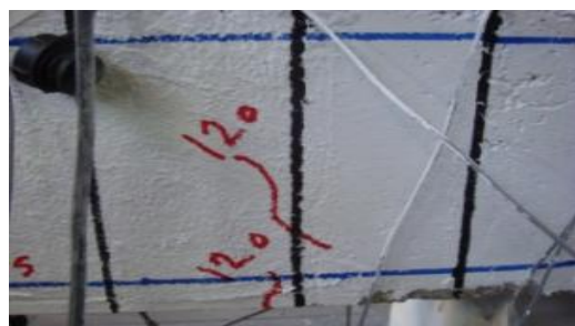
ب) اولین ترک برشی در بار 120 \text{ kN} در نمونه (BFV)
