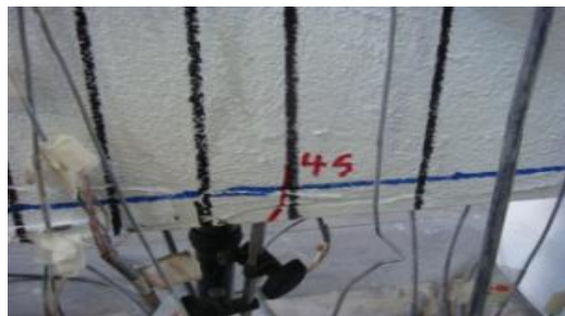
الف) اولین ترک در محل ممان حداکثر در نمونه‌ی (BFV)
