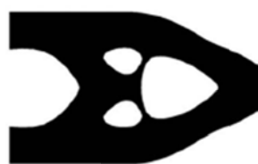
شکل ۱۸ برگرفته از [15] (الف) تیر یک سر گیردار مستطیلی، (ب) تغییرات تابع هدف و قید حجم، (ج) تغییرات ساختاری در فضای فیزیکی و پارامتری مسئله، (د) پروفیل بهینه
