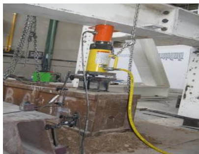
شکل ۷ نصب تغییر مکان سنج برای اندازه‌گیری تغییر مکان‌های قایم قالب‌ها
