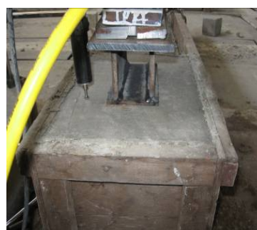
شکل ۵ تکیه‌گاه فلزی منتقل‌کننده‌ی بار
