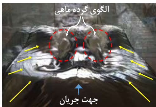
شکل «۱۱»: همگرایی جریان به سمت محور مرکزی کانال متأثر از دیواره کانال و کلیدهای خروجی سرریز کلید پیانویی با فرم هندسی تاج زیگزاگی. Q=41.98 \text{ lit/s}
