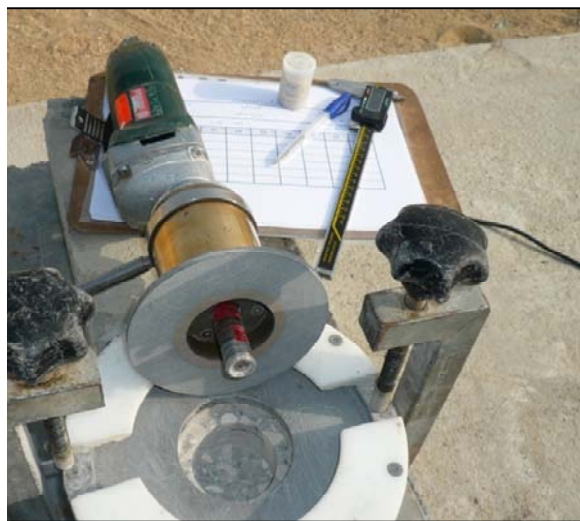
شکل ۳ جزئیات عملیات پودرگیری از آزمون‌ها در محل سایت تحقیقاتی
