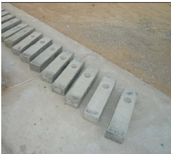
شکل ۳ جزئیات عملیات پودرگیری از آزمون‌ها در محل سایت تحقیقاتی
