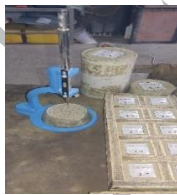
شکل ۶: گیرش نمونه آزمایشی تحت آزمایش ویکت
