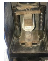
شکل ۵: نمونه استوانه‌ای تحت آزمایش کشش برزیلی
