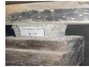
شکل ۳: مقاومت فشاری نمونه ملات ژئوپلیمر ساخته شده از کائولن و سرباره
