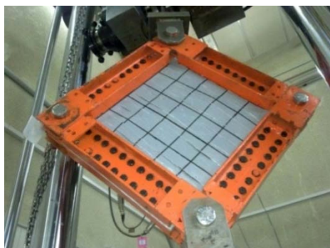
شکل ۱۰ پدیده‌ی لایه-لایه شدن و پارگی در لایه‌ی پلیمری در نمونه‌ی CSPSP2
