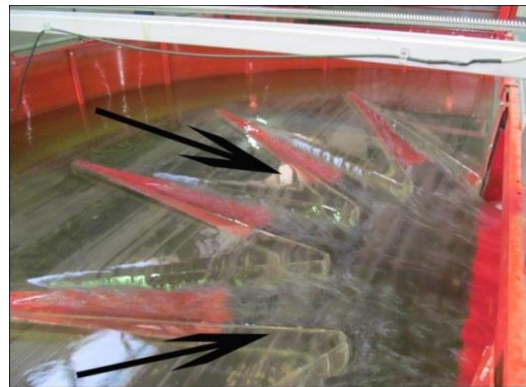
شکل ۵. نمایی دیگر از سرریز، شیب پایین دست و شکل‌گیری جریان بر روی سرریز (بستر شیب‌دار با رنگ قرمز مشخص شده است)
