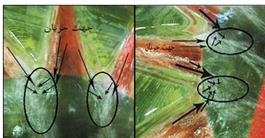
شکل ۶ گردابه‌های به وجود آمده در اثر شیب دیواره پایین دست
