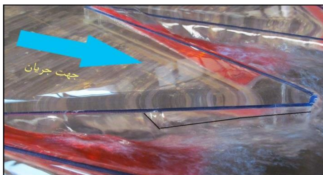
شکل ۸ هواگیری جریان تا ابتدای شیب‌ها در Q = 42 \frac{\text{lit}}{\text{s}}
