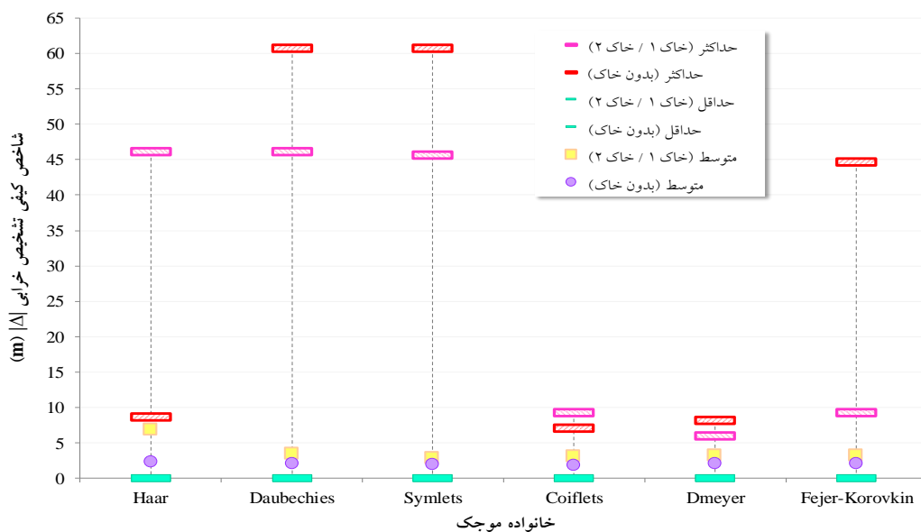
شکل ۷ شاخص کیفی تشخیص خرابی موجک‌های متعامد به‌ازای سناریوهای خرابی ۱ الی ۹
