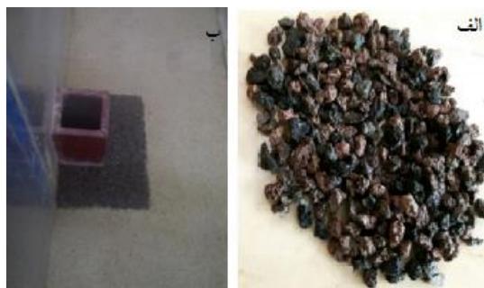
شکل ۳ الف) سنگ‌ریزه مورد استفاده در آزمایش، ب) کارگذاری سنگ‌ریزه پیرامون تکیه‌گاه با دیواره قائم
