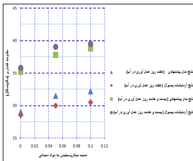
شکل ۱۲ مقایسه بین نتایج مقاومت فشاری بیسوال (حاوی میکروسیلیس) و مدل پیشنهادی [21]
