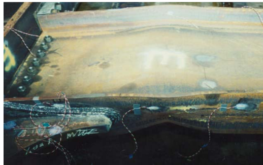
(الف) تغییر شکل نمونه آزمایشگاهی HH-8 در انتهای بارگذاری [1,2]
