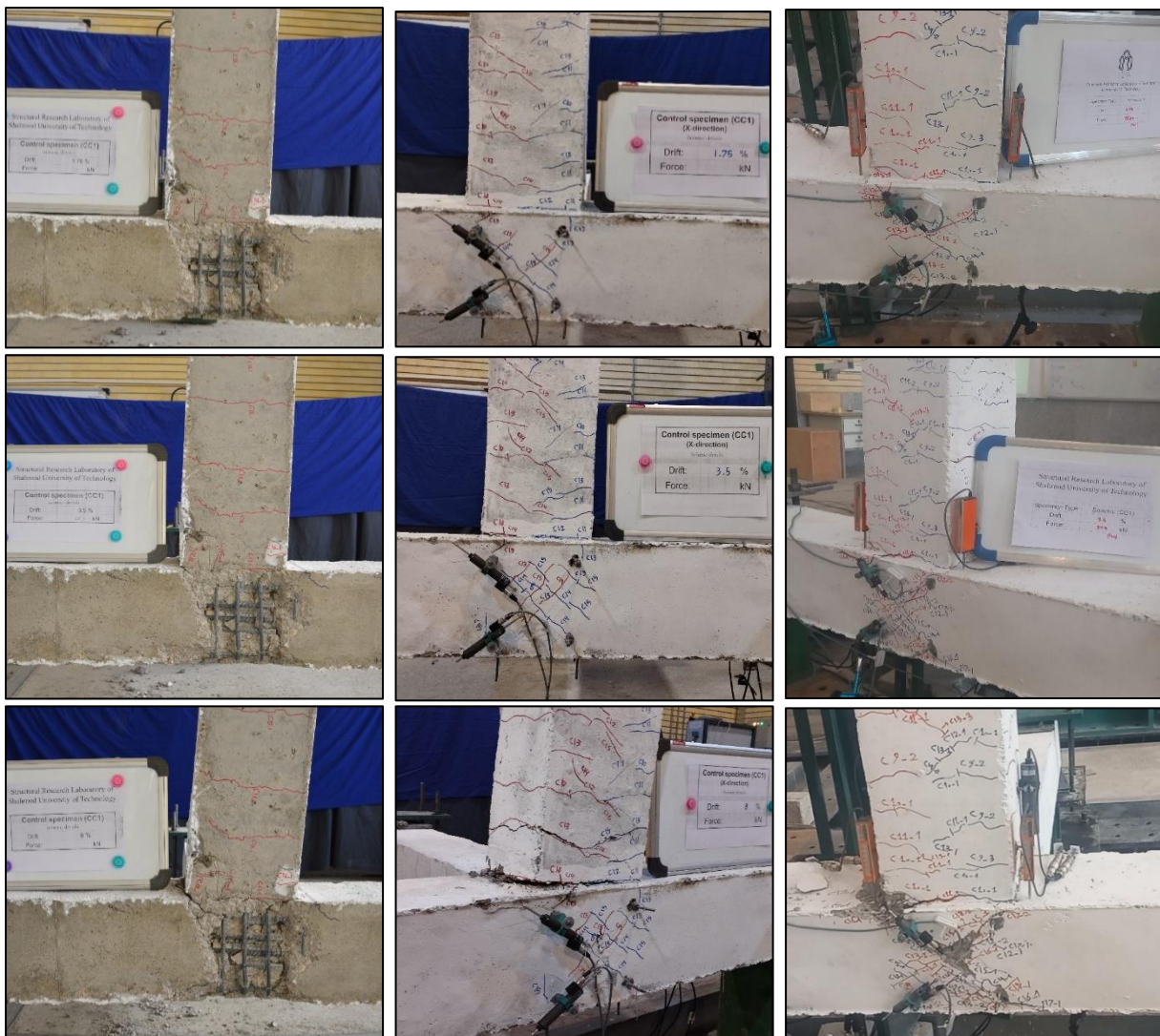
شکل ۱۰ رشد ترک‌ها و پیشرفت خرابی نمونه‌های C1 در جابه‌جایی نسبی ۱٫۷۵٪، ۳٫۵٪ و در انتهای تست
