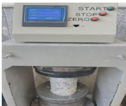
شکل ۷ آزمون مقاومت فشاری نمونه‌ها توسط جک
