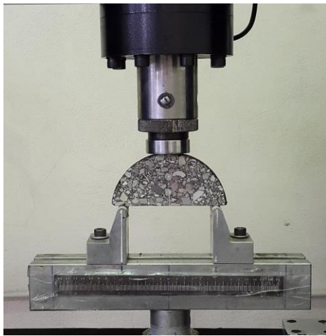
شکل ۴ نحوه قرارگیری نمونه در دستگاه یونیورسال
