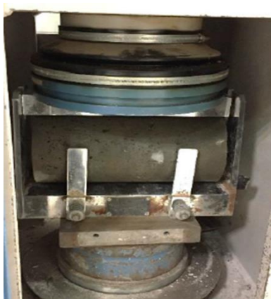
شکل ۴ مقاومت کششی بر روی نمونه‌های استوانه‌ای
