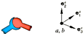
شکل ۸ اتصال دهنده مفصلی در نرم‌افزار آباکوس
