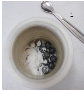
شکل ۴ نحوه تهیه ذرات سیمان، الف- دستگاه آسیاب سیاره‌ای، ب- قرارگیری محفظه استوانه‌ای داخل آسیاب، ج- محفظه دستگاه شامل گوی‌ها و نانو سیمان، د- آماده سازی نمونه‌ها برای ارسال جهت عکس برداری الکترونیکی.
