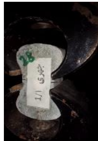
شکل ۴ شکست نمونه بریکت در آزمایش کشش مستقیم
