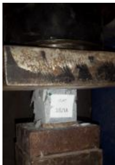
شکل ۲ شکست نمونه مکعبی در آزمایش مقاومت فشاری
