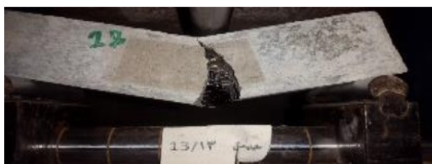
شکل ۳ شکست کامپوزیت سیمانی حاوی الیاف فولادی در آزمایش
