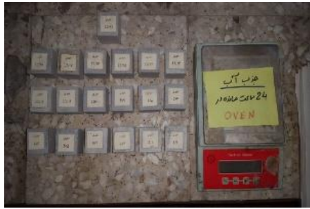
شکل ۵ توزین نمونه‌ها در آزمایش جذب آب
