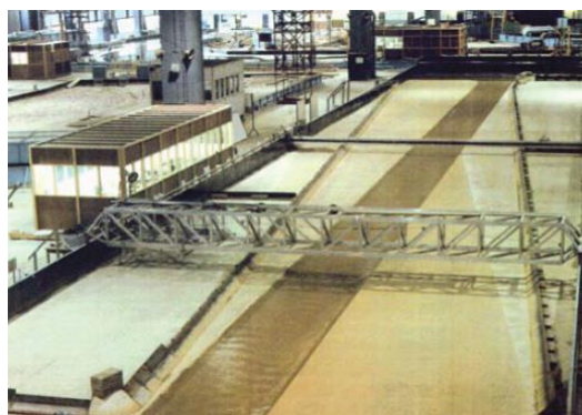
شکل ۱ تصویری از کانال مرکب با سیلاب دشت‌های مورب (زاویه اریب ۵/۱ درجه) مستقر در والینگفور
