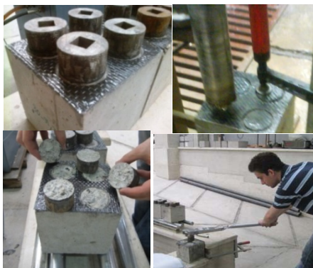
شکل ۴ آماده‌سازی نمونه‌های مکعبی با CFRP و انجام آزمایش «پیچش»
