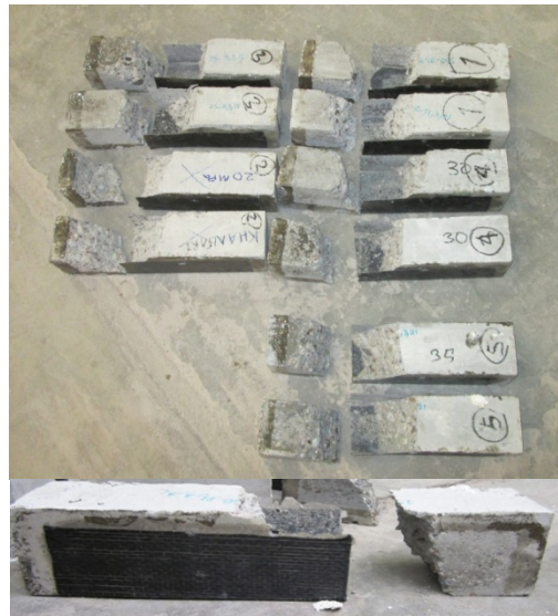
شکل ۱۴ شکست تیرهای تقویت شده با CFRP
