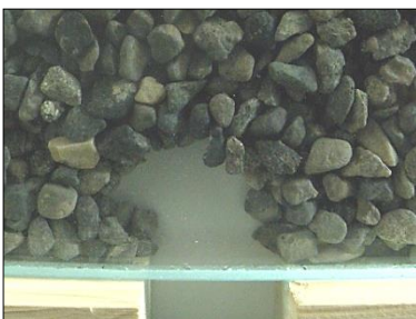
پ) مجموعه سنگریزه شکل ۱۱ نمونه‌ای از قوس‌های بحرانی
