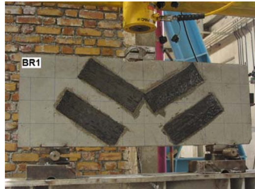
شکل ۳ آرایش CFRP در تیر BR1
