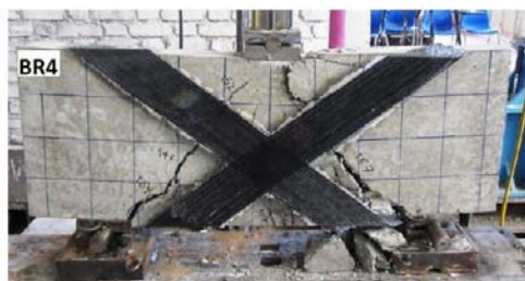
شکل ۷ نحوه خرابی گروه دوم نمونه‌ها
