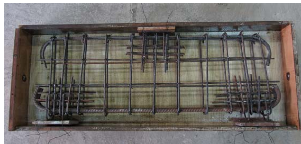
شکل 1 جزئیات آرماتورگذاری و تقویت های صورت گرفته در محل اعمال بار و تکیه گاه ها برای جلوگیری از وقوع خرابی لهیدگی تکیه گاهی
