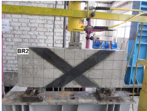
شکل ۴ آرایش CFRP در تیر BR2
