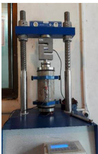
شکل ۳ لحظه شکست نمونه استوانه‌ای تحت آزمایش مقاومت مدول الاستیسیته
