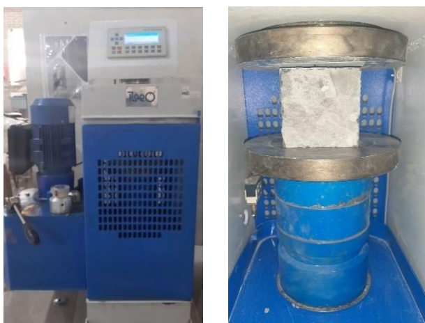
شکل ۶ آزمایش مقاومت فشاری نمونه‌های بتن سبز حاوی الیاف پلی-
