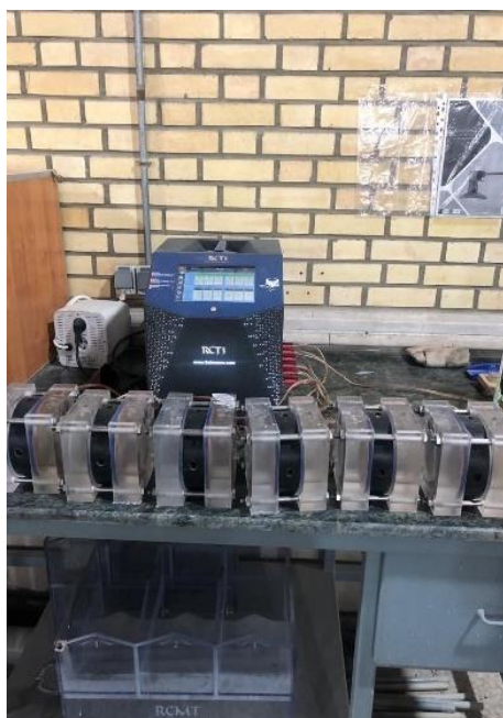
شکل ۸ آزمایش نفوذپذیری (RCPT)
