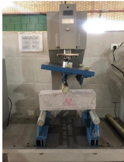
شکل ۷ آزمایش مقاومت خمشی نمونه‌های بتن سبز حاوی الیاف پلی- پروپیلن و خاکستر باگاس با استفاده از جک هیدرولیکی
