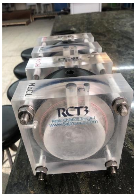
شکل ۸ آزمایش نفوذپذیری (RCPT)
