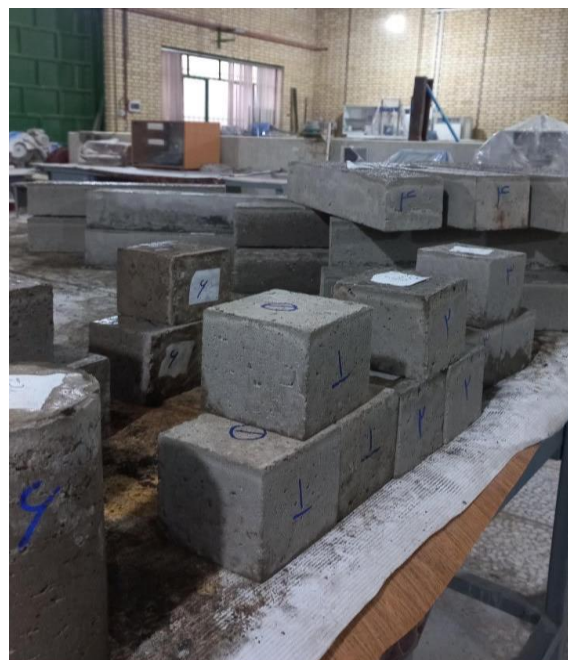
شکل ۵ نمونه‌های بتنی پس از ساخت
