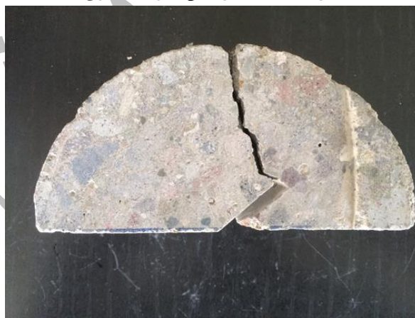
شکل ۵- نمونه نیم دایره‌ای ترک خورده و دستگاه بارگذاری
