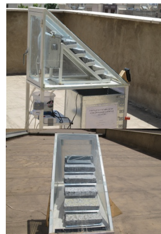
شکل ۱ طرح شماتیک فتورآکتور خورشیدی مورد استفاده: A: پلکان بتنی، B: مخزن تغذیه، C: پمپ، D: شیر نمونه‌گیری، E: حمام ترموستاتیک، F: لوله رابط، G: سرریز، H: هواده، I: صفحات شیشه‌ای ۳ میلی‌متر
