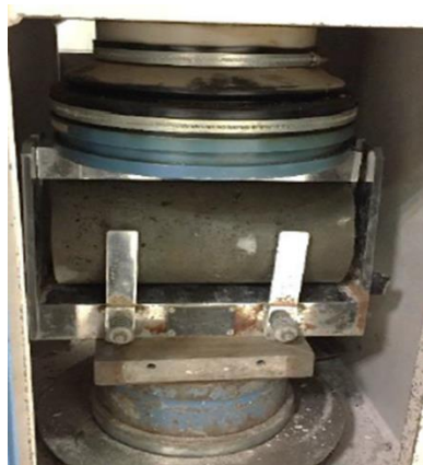
شکل ۴ مقاومت کششی بر روی نمونه‌های استوانه‌ای
