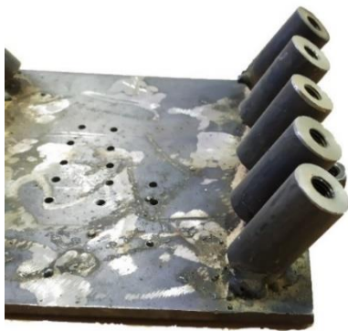
شکل ۱. نمایی از کوپلرهای متصل شده به پی
