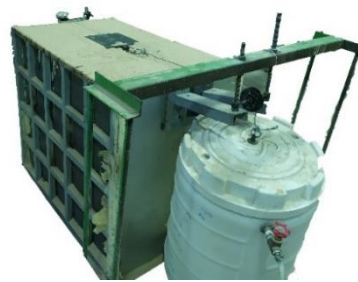
شکل ۳ مخزن ماسه به همراه قاب و مخزن آب بارگذاری
