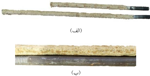
شکل ۲ الف) ریزشمع در دو طول ۴۰ و ۶۰ سانتی‌متر، ب) سطح ریزشمع ماسه اندود شده و فاقد اندود در کنار یکدیگر
