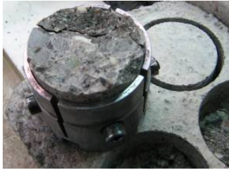
ج) لایه تعمیر پس از انجام آزمون شکل ۲ انجام آزمون انتقال اصطکاک
