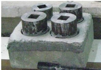
الف) چسباندن استوانه های فلزی روش پیچش به نیم مغزه ها
